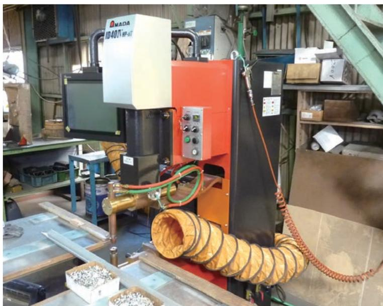
汎用プレス、スポット溶接機、半自動溶接機、ロボット溶接機などを用いて、S S鋼材、亜鉛メッキ鋼板を中心とした加工を行っています。最近では、ステンレス鋼板の加工やアルミ製の鉄道車両部品も手掛け始めました。
