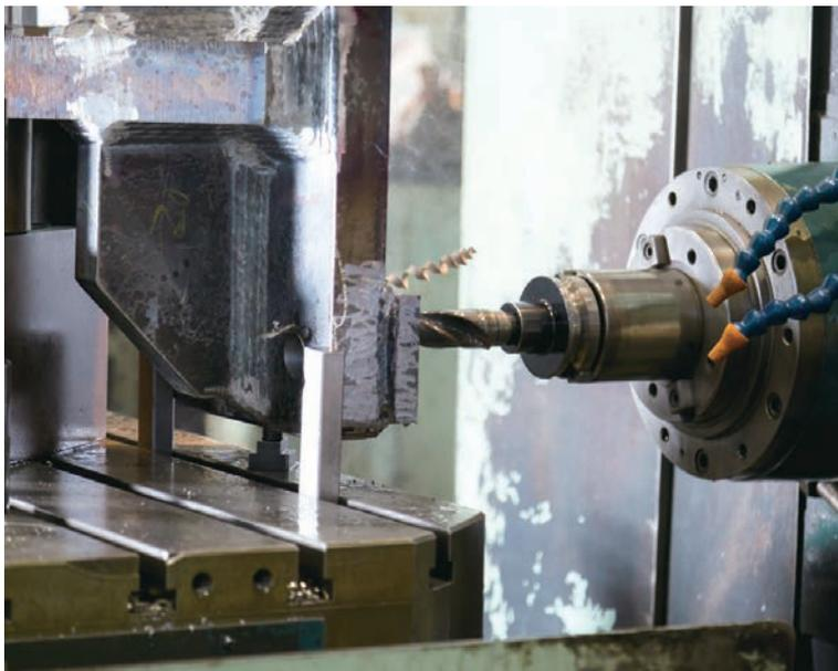
昭和22年創業、当初より鑄造及び機械加工を行ってまいりました。現在は鑄造部門を廃止し、機械加工を主体に行っています。超大型の加工物は困難ですが、「精密加工」と「大ロット加工」を得意としております。具体的な加工部品は、鉄鋼・製鋼設備関連、車両関連、半導体関連で、大きさは角もので2,000mm×2,000mm、丸もので直径1,500mm、長さ4,000mm程度、ライナー類で長さ6,000mm程度まで加工可能です。取り扱い材料は、炭素鋼、合金炭素鋼、ステンレス鋼及びアルミ、チタン、銅合金その他の金属系を扱っており、鍛造品、鑄鋼品等も調達しています。製作数量は、単品製作からロボット使用による加工で数百～数千個のロットを受注しております。
