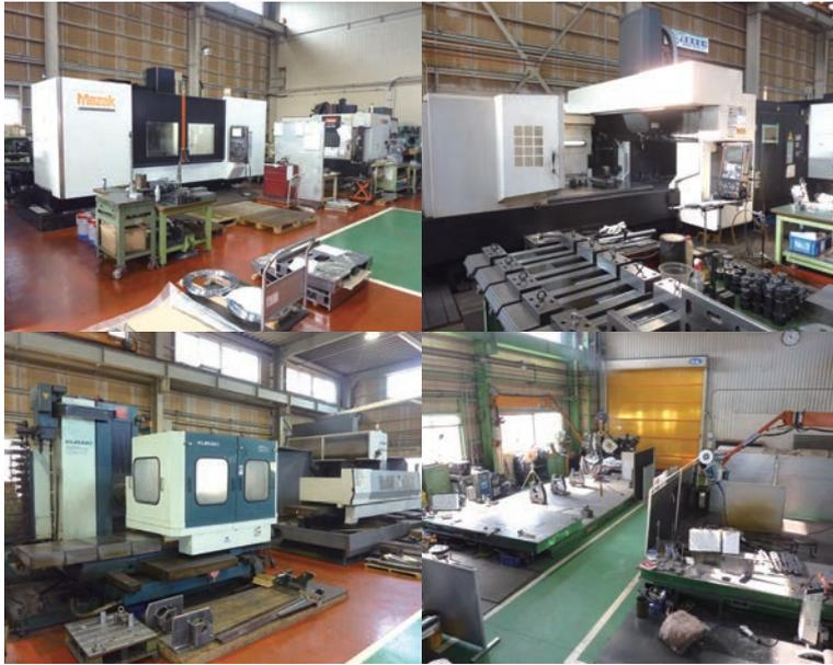
マシニングセンター、NCフライス盤、NC旋盤、NC横中グリ盤などの加工設備による高精度機械加工と、鉄、ステンレス、アルミなどの精密溶接加工による各種機械部品製作を行っています。
