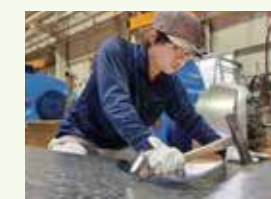
打ち出し板金作業
