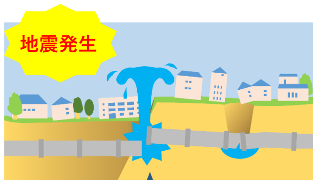
古い配水管（非耐震管）
